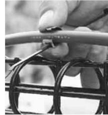
②センサにセンサ取付金具 (FKS-K3) を取り付けます。
