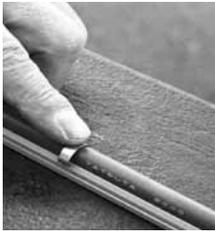
③固定レールにFKS-L6に付属のセンサ取付金具を固定。
